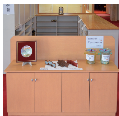
雪止め。左から、西日で著しく錆びたもの、北側の雪でゆがんだもの、新設のもの
